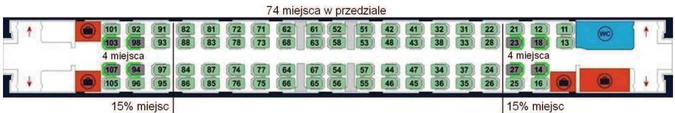
Rys. 9. Przykładowa lokalizacja miejsc uprzywilejowanych w wagonie z drzwiami wejściowymi na końcu pojazdu [opracowanie własne]
