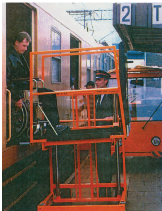
Rys. 3. Podnośnik peronowy dla osób poruszających się na wózkach inwalidzkich [źródło: Prospekt ZNTK Nowy Sącz – obecny NEWAG]
