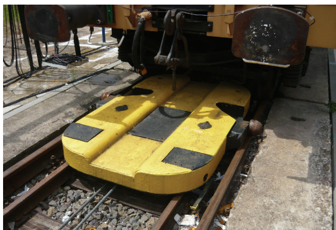
Rys. 6. Badawcza górka rozbiegowa – przeciągarka [fot. R. Skóra]
