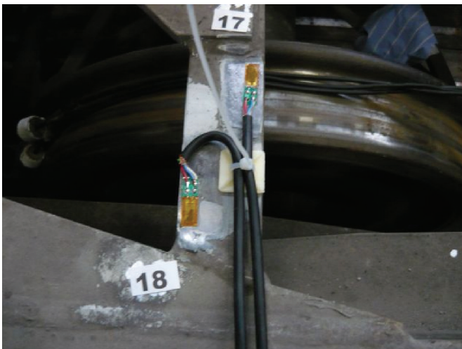
Rys. 8. Widok przyklejonych tensometrów do pomiaru naprężeń / odkształceń wagonu [fot. R. Skóra]
