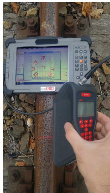
Rys. 3. Pomiar zarysu profilu główki szyny przyrządem pomiarowym Calipri C40 [fot. A. Aniszewicz]
