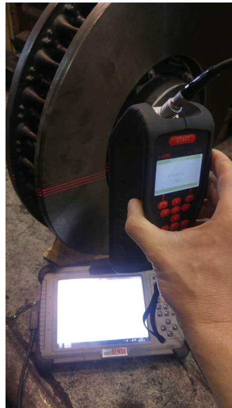
Rys. 2. Pomiar zużycia powierzchni ciernych tarcz hamulcowych przyrządem pomiarowym Calipri C40 [fot. A. Aniszewicz]
