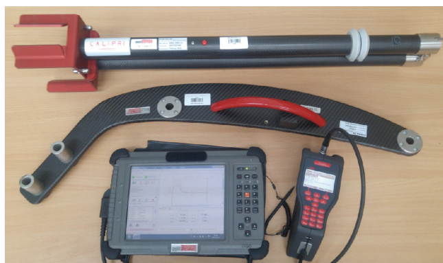
Rys. 4. Zestaw urządzeń przyrządu pomiarowego Calipri C40 przygotowany do pomiaru parametrów zestawu kołowego wagonu kolejowego [fot. A. Aniszewicz]
