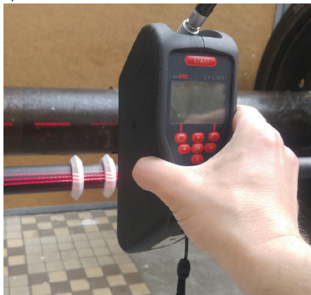
Rys. 1. Pomiar przyrządem pomiarowym Calipri C40: a) zarysu profilu tarczy koła jezdnego, b) średnicy na okręgu tocznym tarczy koła jezdnego, c) rozstawu tarcz kół zestawu kołowego [fot. A. Aniszewicz]
