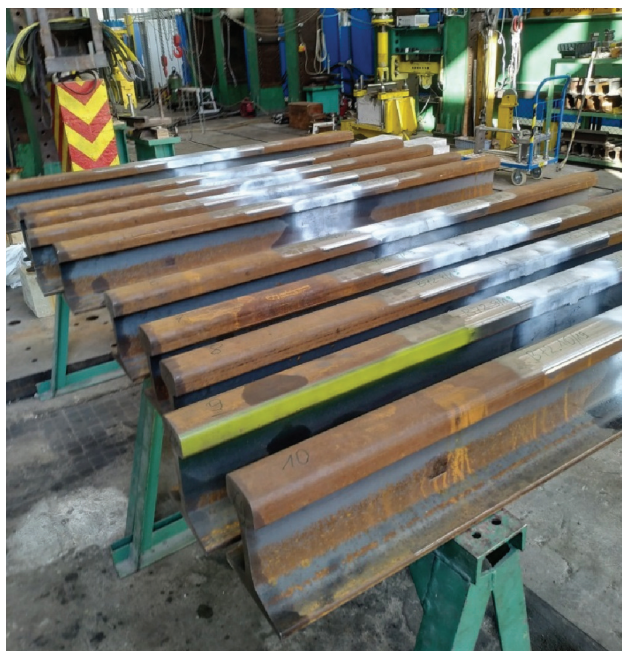
Rys. 1. Komplet dziesięciu próbek szyn ze zgrzeinami po badaniach geometrycznych oraz magnetyczno-proszkowych [fot. M. Ostromięcka]
