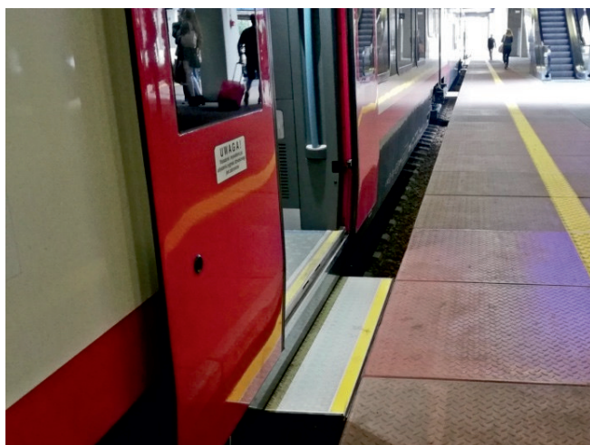
Rys. 4. Wysuwany stopień z konstrukcji wagonu zespołu trakcyjnego przysłaniający lukę [fot. P. Brona]
