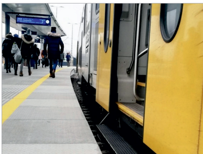
Rys. 2. Luka pomiędzy peronem i stopniami wagonu na odcinku toru położonym w łuku [fot. P. Brona]
