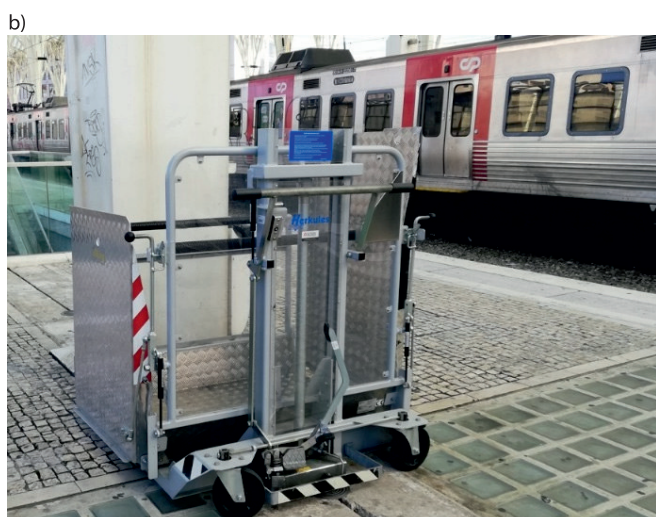
Rys. 6. Przykłady podnośników dla osób niepełnosprawnych na wózkach inwalidzkich na peronie na dworcach w Paryżu (a) i Lizbonie (b) [fot. P. Brona]
