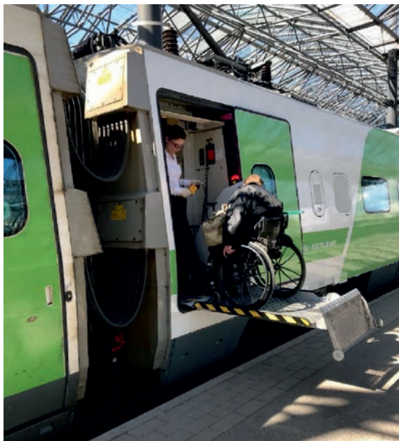
Rys. 3. Podnośnik wagonowy dla osób niepełnosprawnych w pociągu Pendolino kolei fińskich (VR) [fot. Arja Aalto]
