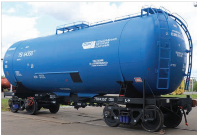
Rys. 2. Cysterna do przewozu produktów naftowych model 15-9993 [2]
