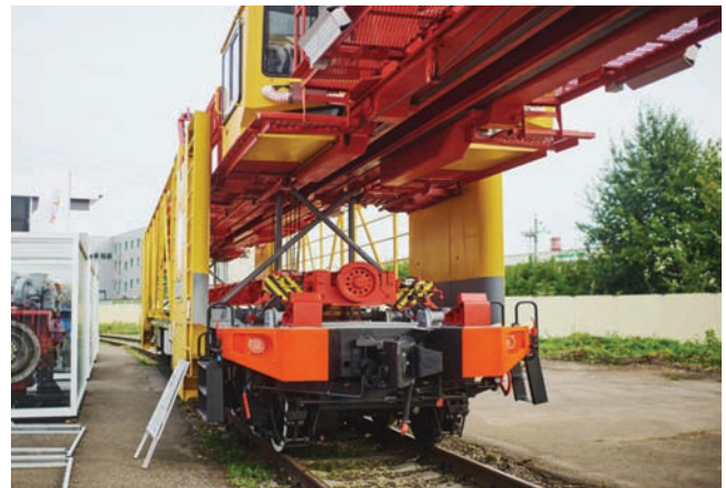
Rys. 11. Dźwig do układania przęseł torowych [8]
