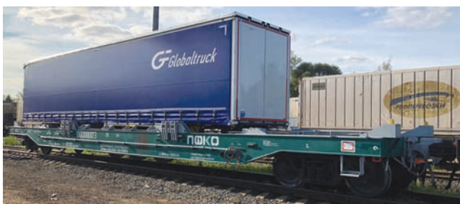
Rys. 16. Wagon kieszeniowy do przewozu naczep drogowych [12]
