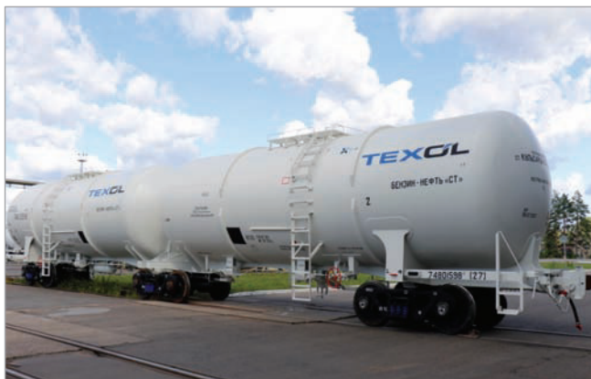
Rys. 1. Sześćoosiowa cysterna przegubowa do przewozu lekkich produktów naftowych, model 15-629 [2]
