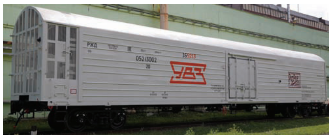
Rys. 20. Wagon chłodnia – model 16-5213 [13]
