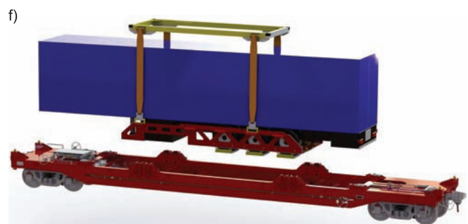
Rys. 17. Technologia załadunku naczepy na wagon [12]: a) widok nadwozia wagonu, b) kosz załadunkowo-mocujący, c) wagon z koszem, d) wjazd pojazdu z naczepą na kosz, e) zamocowanie odpiętej naczepy w koszu, f) załadunek kosza z naczepą na wagon
