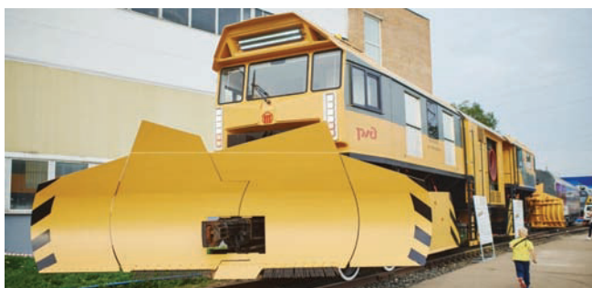
Rys. 18. Samobieźny pług odśnieżny SS-POM [7]
