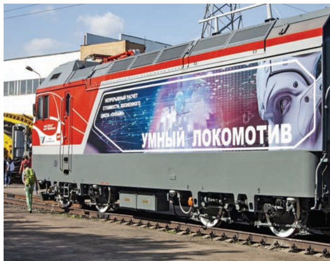
Rys. 7. Lokomotywa elektryczna prądu zmiennego typu 2ES7 [6]
