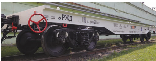
Rys. 19. Wagon platforma do przewozu kontenerów – model 13-192-03 [13]
