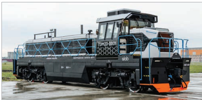
Rys. 12. Lokomotywa manewrowa typu TEM23 [fot. Transmashholding]
