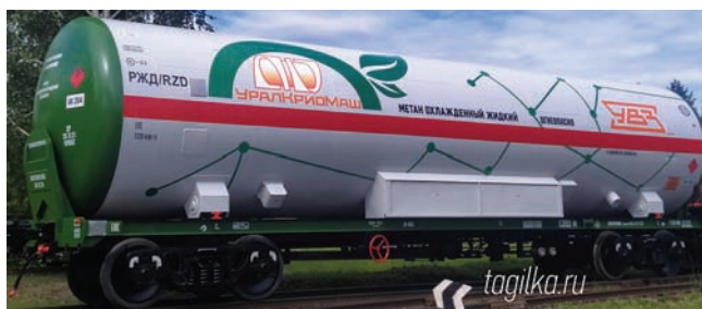
Rys. 21. Cysterna do przewozu skroplonego gazu ziemnego [14]
