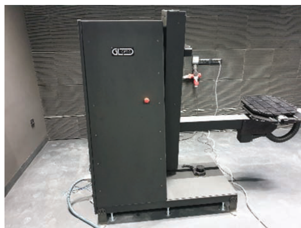
Rys. 3. Goniometr typu GLGA 50-1800 do pomiarów fotometrycznych [fot. Ł. John]
