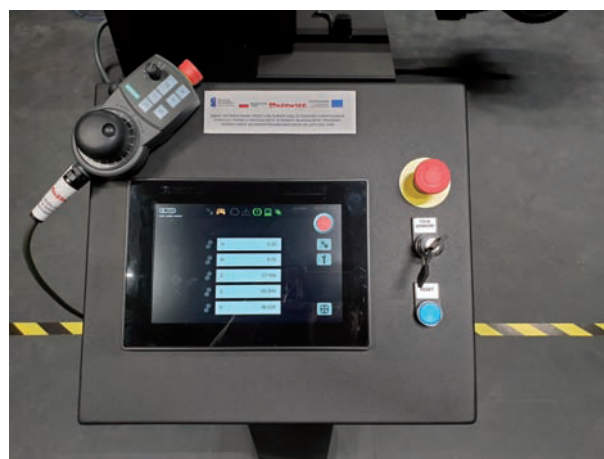
Rys. 4. Sterownik ręczny (pulpit) i zadajnik ręczny do ustawiania badanego obiektu na goniometrze [fot. Ł. John]
