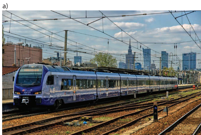
Rys. 8. Elektryczny zespół trakcyjny typu ED160 do przewozów międzywojewódzkich: a) widok pojazdu [55], b) wnętrze pojazdu [56]
