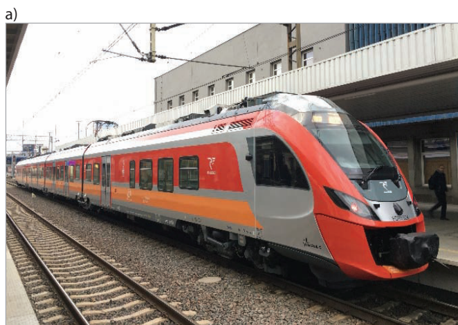
Rys. 7. Elektryczny zespół trakcyjny typu ED78 do przewozów wojewódzkich: a) widok pojazdu [53], b) wnętrze pojazdu [54]
