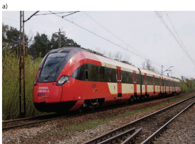
Rys. 6. Elektryczny zespół trakcyjny typu 19WE do przewozów aglomeracyjnych: a) widok pojazdu [51], b) wnętrze pojazdu [52]
