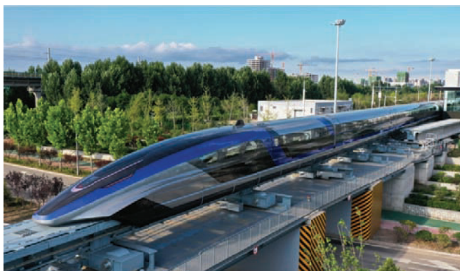
Rys. 10. Pociąg Maglev zdolny do rozwijania prędkości 600 km/h na torze testowym China Railway Rolling Stock Corporation [26]
