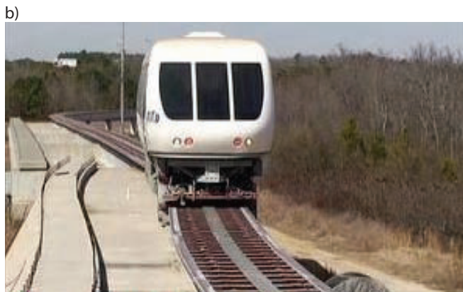
Rys. 11. Koncepcja American Maglev Technology (AMT): a) pojazd przy peronie [34], b) tor doświadczalny wraz z pojazdem [35]
