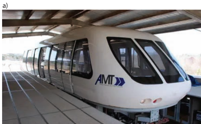
Rys. 11. Koncepcja American Maglev Technology (AMT): a) pojazd przy peronie [34], b) tor doświadczalny wraz z pojazdem [35]
