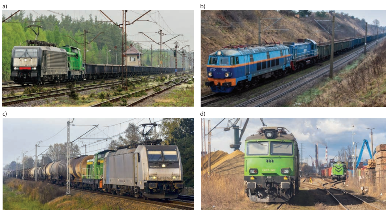
Rys. 15. a–c) Poglądowe rysunki obrazujące przewożenie własnych lokomotyw spalinowych do wykonywania operacji manewrowych u odbiorców ładunków [78, 79, 80], d) odstawione liniowe lokomotywy elektryczne i realizująca manewry lokomotywa spalinowa [77]
