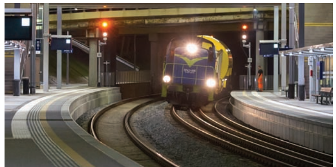
Rys. 5. Przejazd pociągu towarowego z ładunkiem ponadgabarytowym po torze splecionym na wysokości przystanku PKM Gdynia Karwiny [69]
