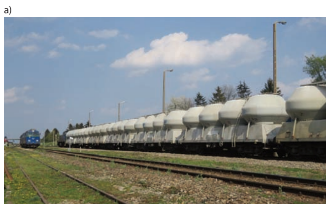
Rys. 2. Przykłady składów całopociągowych: a) wahadło do przewozu cementu luzem [53], b) wahadło do przewozu paliw płynnych [54]
