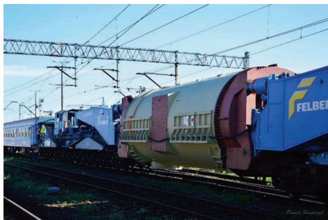
Rys. 6. Pociąg specjalny z ładunkiem ponadgabarytowym na wagonie NORCA24 [63]; po prawej wagon osobowy dla personelu konwoju
