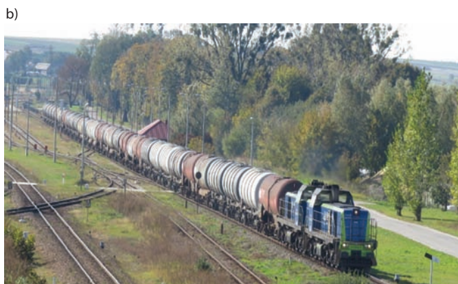
Rys. 2. Przykłady składów całopociągowych: a) wahadło do przewozu cementu luzem [53], b) wahadło do przewozu paliw płynnych [54]
