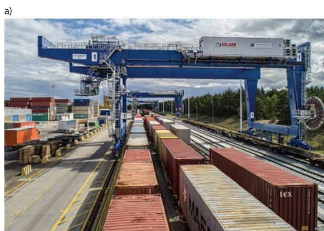
Rys. 13. Przykłady terminali transportu intermodalnego: a) terminal wyposażony w suwnice bramowe [72], b) terminal wyposażony w wozycy podnośnikowe czołowe [73]
