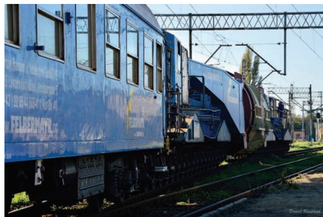
Rys. 6. Pociąg specjalny z ładunkiem ponadgabarytowym na wagonie NORCA24 [63]; po prawej wagon osobowy dla personelu konwoju
