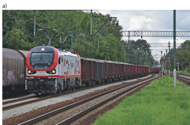
Rys. 14. Lokomotywa dwunapędowa typu 111Ed: a) lokomotywa 111Ed-010 z pociągiem na linii zelektryfikowanej [75], b) lokomotywa 111Ed-024 z pociągiem na linii niezelektryfikowanej [76]
