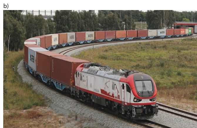
Rys. 14. Lokomotywa dwunapędowa typu 111Ed: a) lokomotywa 111Ed-010 z pociągiem na linii zelektryfikowanej [75], b) lokomotywa 111Ed-024 z pociągiem na linii niezelektryfikowanej [76]
