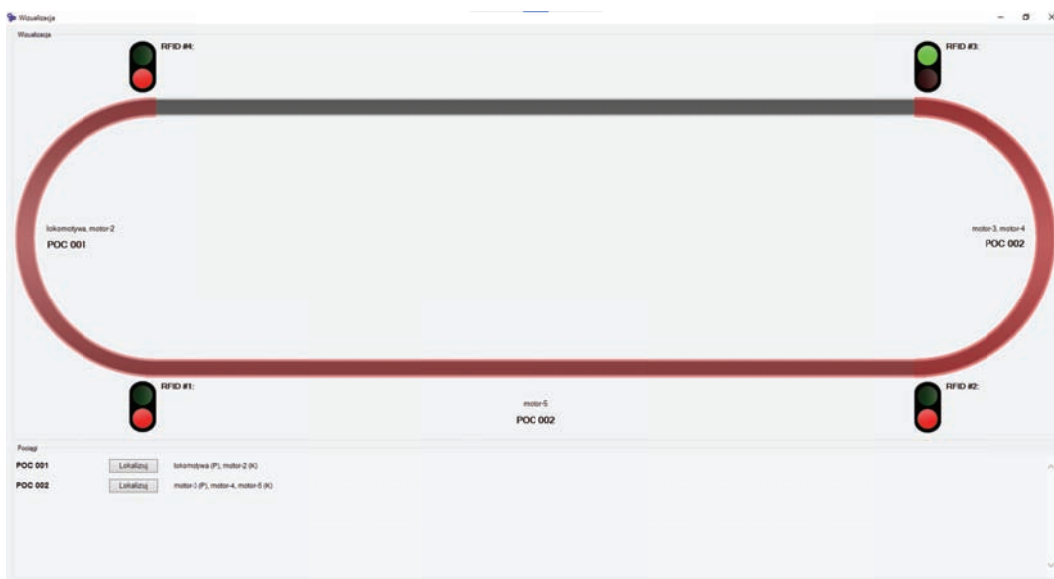
Rys. 16. Trzy odcinki toru zajęte przez pociągi POC-001 i POC-002 [z materiałów autora]
