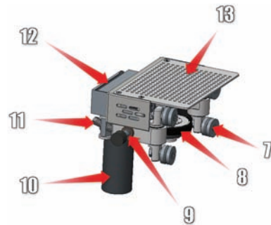
Rys. 6. Wózek pomiarowy i jego elementy [7]: 7) koła prowadzące, 8) koło napędowe, 9) zderzak, 10) silnik bezszczotkowy BLDC (ang. BrushLess Direct-Current motor ), 11) sprężyna dociskowa, 12) akumulator i układ sterowania, 13) platforma robocza (płyta perforowana) do montażu badanych modeli obiektów
