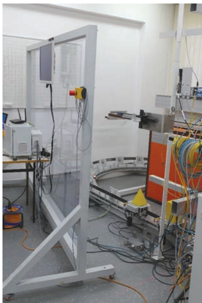
Rys. 26. Oslona bezpieczeństwa oddzielająca stanowisko pracy operatora od toru [fot. J. Moczarski]
