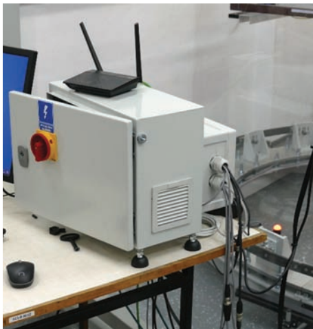
Rys. 17. Jednostka sterująca ruchem wózków [fot. J. Moczarski]
