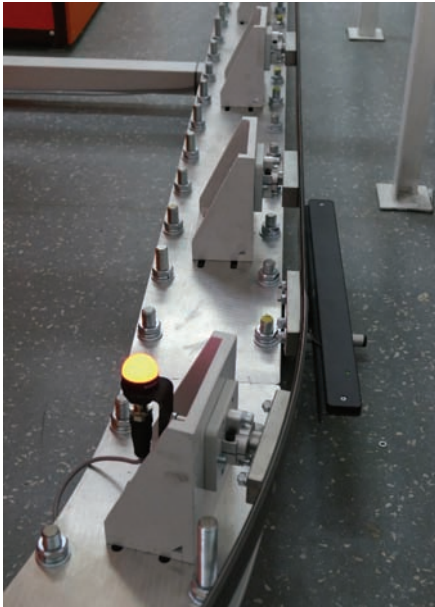
Rys. 11. Sygnalizator (światło czerwone) i antena RFID [fot. J. Moczarski]
