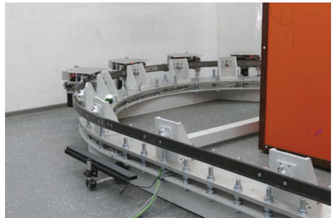
Rys. 14. Kolejny odcinek wolny – sygnał zezwalający na jazdę (światło zielone) [fot. J. Moczarski]
