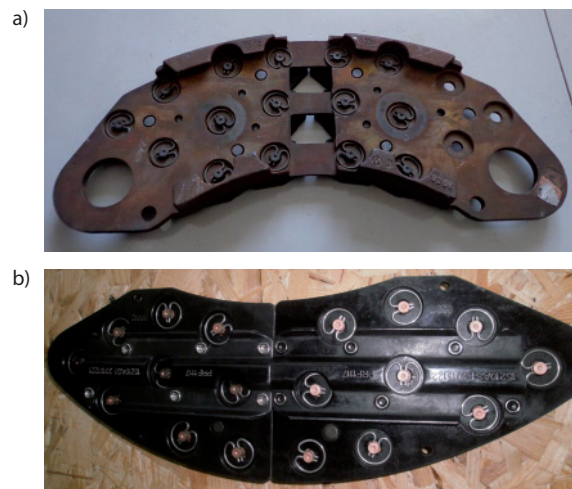
Rys. 5. Mocowanie okładzin w obszarze hamulcowej: a) system ISOBAR, b) system UIC [fot. J. Kukulski]
