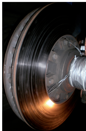
Rys. 7. Widok tarczy hamulcowej używanej w badaniach okładzin hamulcowych [fot. J. Kukulski]
