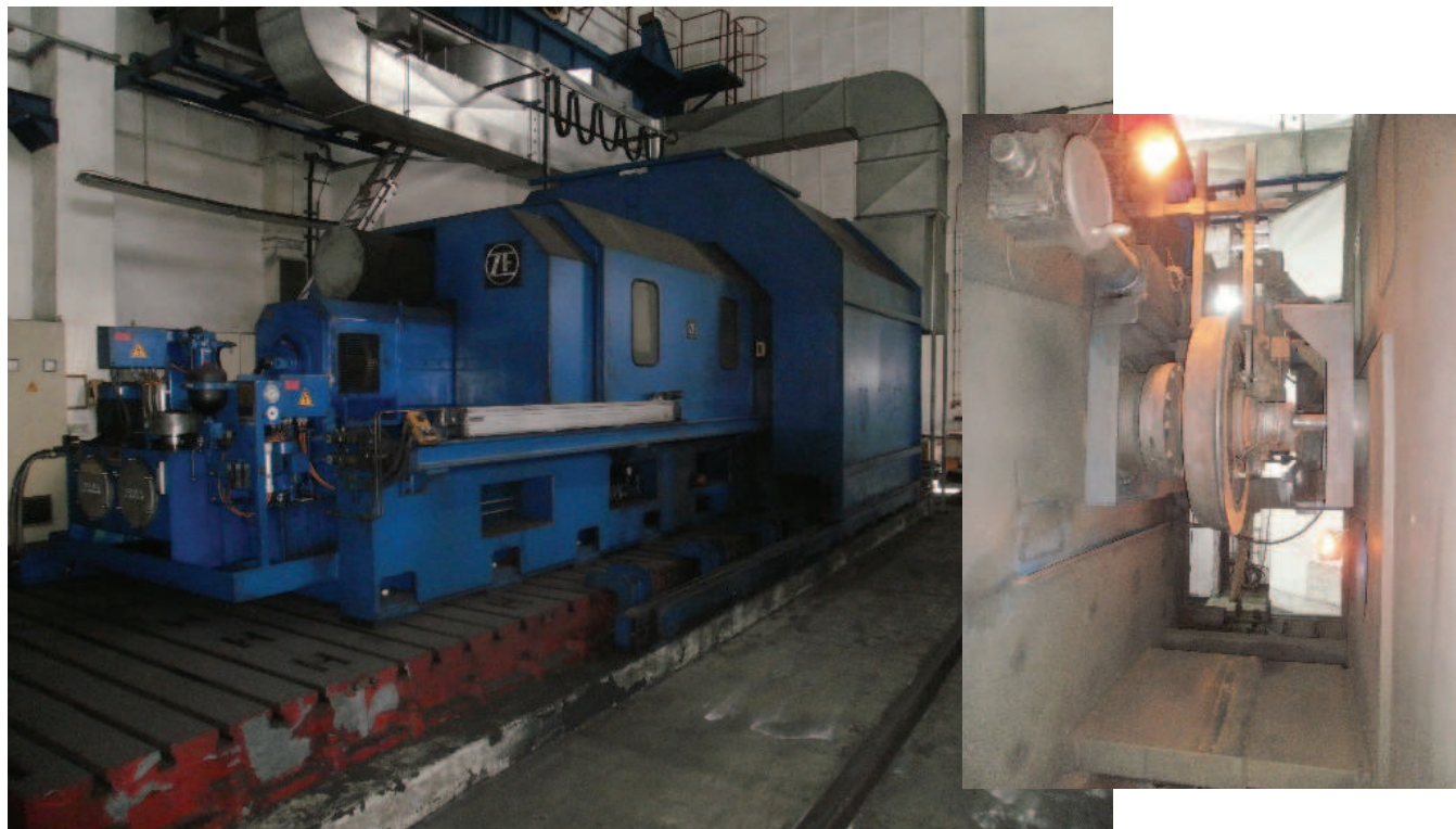
Stanowisko dynamometryczne do badania par ciernych hamulca kolejowego (widok ogólny i kabiny badawczej) [fot. archiwum Laboratorium Badań Taboru]
