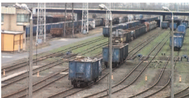
Rys. 13. Węglarka ładowna dopędza odpręg złożony z dwóch próżnych węglarek w strefie hamulca docelowego [fot. J. Tyszkowski]
