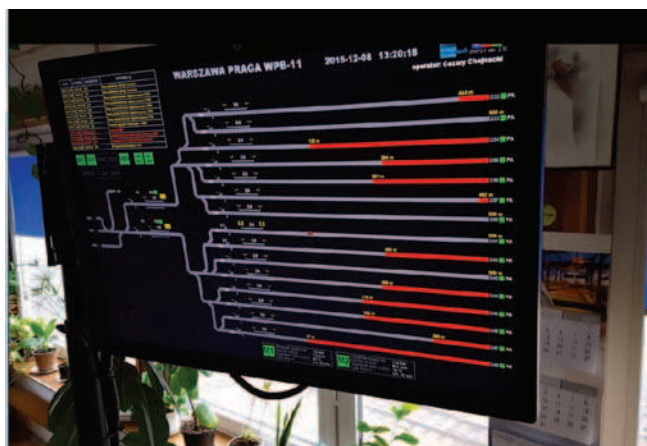
Rys. 7. Zobrazowanie zajętości torów kierunkowych (widok połowy grupy torów) na monitorze systemu wizualizacji SWPG-1 [fot. J. Tyszkowski]
