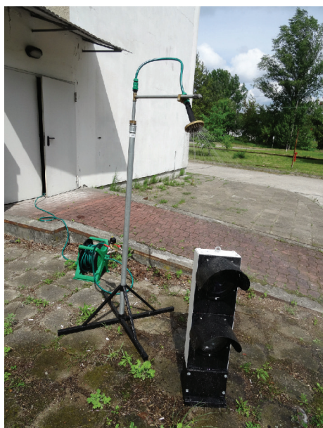
Rys. 5. Semafor karzełkowy typu ELK-221 podczas próby IPX4 [fot. B. Kabacińska]
