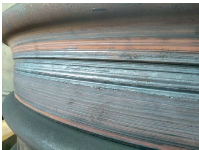
Rys. 6. Destrukcja powierzchni tocznej koła po jednym z badań na obciążenie termiczne [fot. J. Kukulski]
