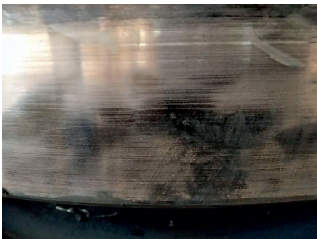
Rys. 13. Widok gorących obszarów na powierzchni tocznej koła monoblokowego [fot. J. Kukulski]
