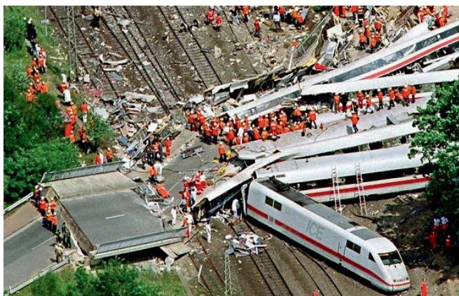
Rys. 1. Skutki wypadku w Eschede w wyniku pęknięcia obręczy koła kolejowego [20]
