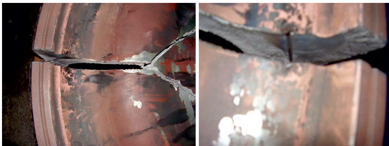
Rys. 8. Przykładowe pęknięcia spowodowane naprężeniami własnymi (termicznymi), z widoczną strefą zmiany struktury materiału wieńca koła [fot. J. Kukulski]
