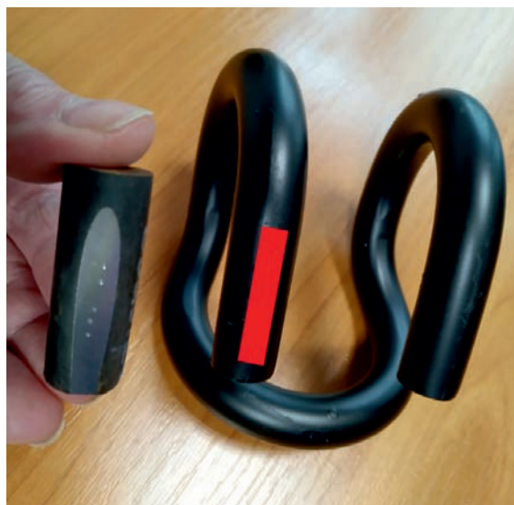
Rys. 4. Łapka sprężysta SB4 z miejscem pomiaru twardości zaznaczonym na czerwono oraz widok na przygotowaną próbkę z odciskami po wykonanych pomiarach twardości [fot. M. Ostromięcka]
