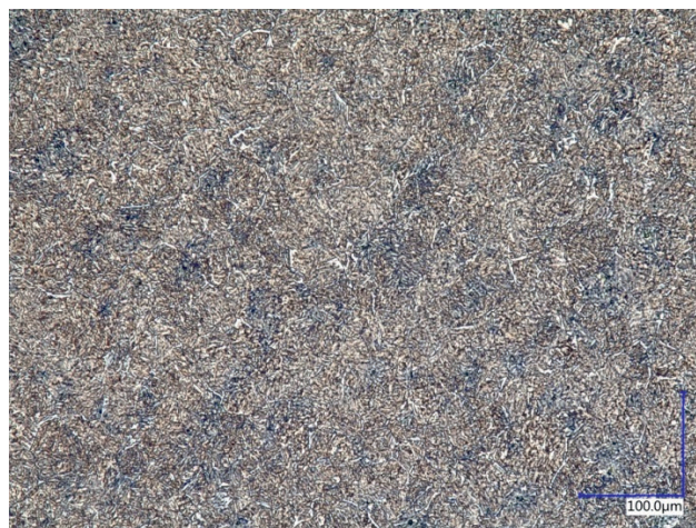
Rys. 2. Mikrostruktura stali 48Si7 łapki sprężystej typu SB4, twardość 42,2 HRC [fot. M. Ostromęcka]
