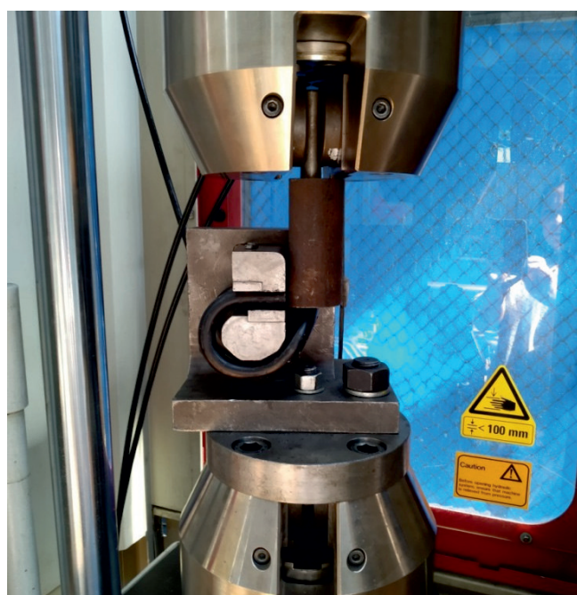
Rys. 8. Badanie siły docisku łapki na maszynie wytrzymałościowej Sinus 250 [fot. M. Ostromecka]
