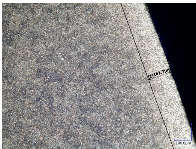
Rys. 3. Pomiar odwęglenia w stali 48Si7 [fot. M. Ostromięcka]
