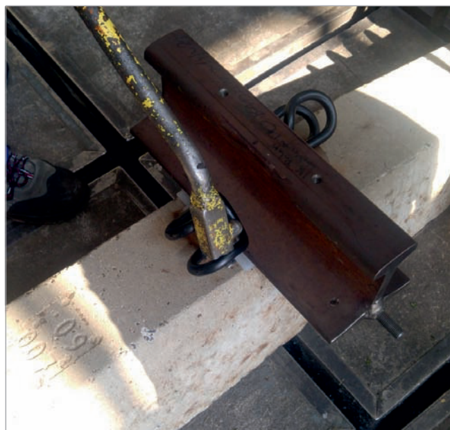
Rys. 7. Montaż łapki SB4 przy badaniu wytrzymałości montażowej [fot. M. Ostromecka]
