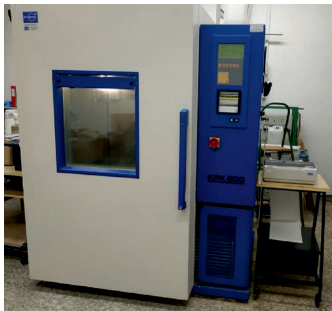
Rys. 3. Komora klimatyczna KPK 3823/15 firmy Feutron GmbH GREITZ [fot. autorzy]
