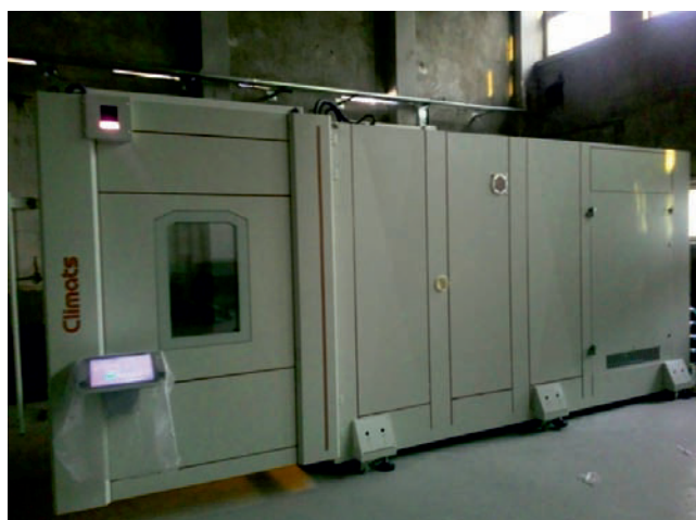
Rys. 4. Komora klimatyczna 6000 H 60/10+4 typ G firmy Climats [fot. autorzy]
