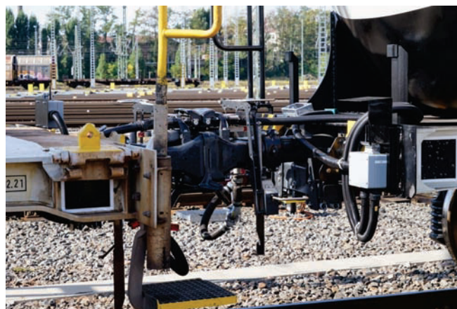
Rys. 6. Widok sprzęgu automatycznego prezentowanego w Halle [7]
