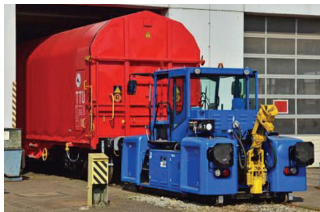
Rys. 28. Pojazd manewrowy szynowo-drogowy serii E-MAXI ze sprzęgiem RK 900 [55]
