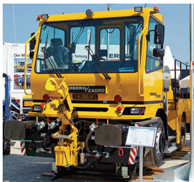
Rys. 29. Dwukierunkowy pojazd manewrowy „TERBERG / ZAGRO Truck RR 282” z automatycznym sprzęgiem manewrowym RK 900 [63]
