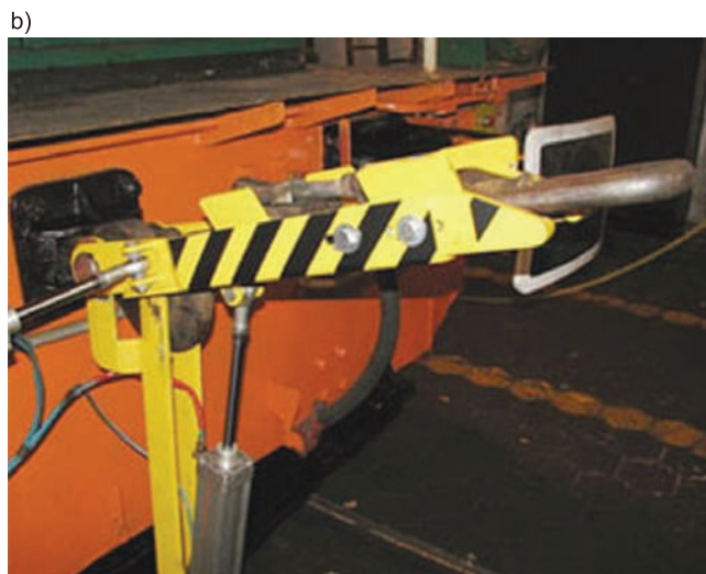
Rys. 32. Zmechanizowany sprzęg śrubowy ZSS-2006 typu L650: a) położenie transportowe [56], b) położenie gotowości do zapięcia na haku wagonu [58]
