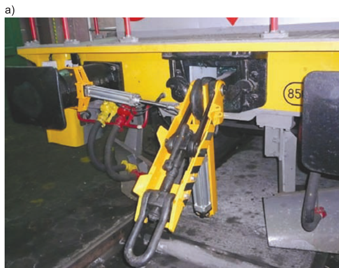
Rys. 32. Zmechanizowany sprzęg śrubowy ZSS-2006 typu L650: a) położenie transportowe [56], b) położenie gotowości do zapięcia na haku wagonu [58]
