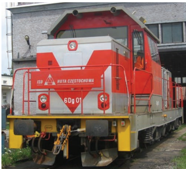
Rys. 31. Lokomotywa manewrowa 6Dg wyposażona w zmechanizowany sprzęg L650 [57]
