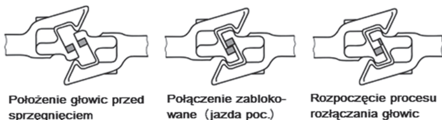
Rys. 11. Główne położenia głowic sprzęgu typu Willsona [13]
