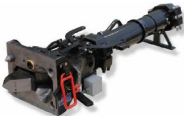
Rys. 22. Część mechaniczna sprzęgu samoczynnego Tomlinsona [49]
