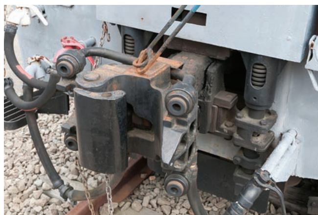
Rys. 10. Zmodernizowany sprzęg typu Janney AAR typ H (Tightlock) stosowany na kolejach japońskich [35]
