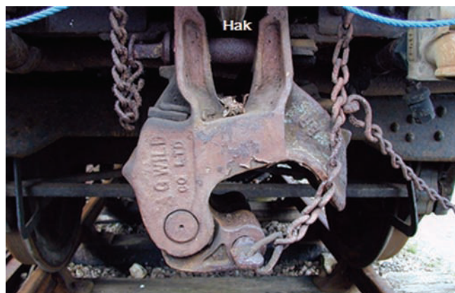
Rys. 6. Sprzęg samoczynny typu Buckeye (złożony, w celu połączenia sprzęgu śrubowego) stosowany w przeszłości w Wielkiej Brytanii [38]
