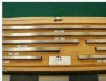
Płytki wzorcowe o dł. nominalnej (125 ± 500) mm
