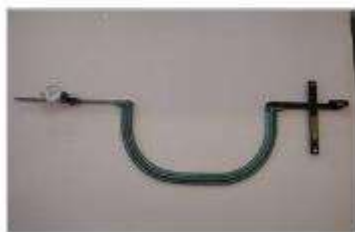
Przyrządy do pomiaru średnicy okręgu tocznego ze stykiem dwupunktowym
