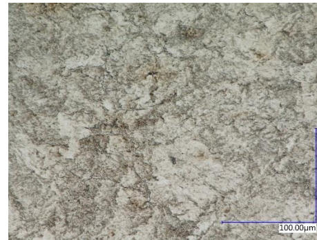
Mikrostruktura w linii zgrzewania w stali R260 w stopce (pow. x1000)
