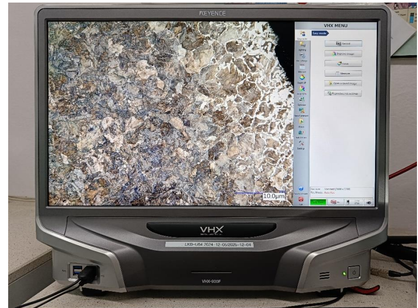
mikroskop optyczny firmy KEYENCE VHX-900F
