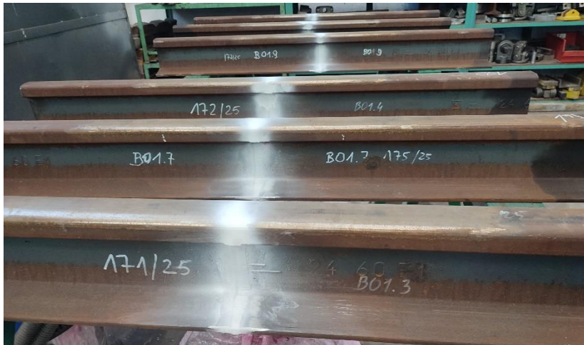
Szyny po badaniu penetracyjnym
