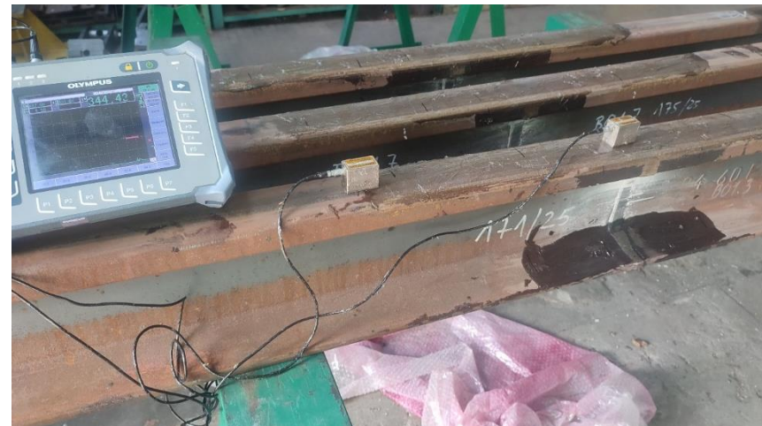
Złącze podczas badania dwiema głowicami kątowymi techniką tandem
