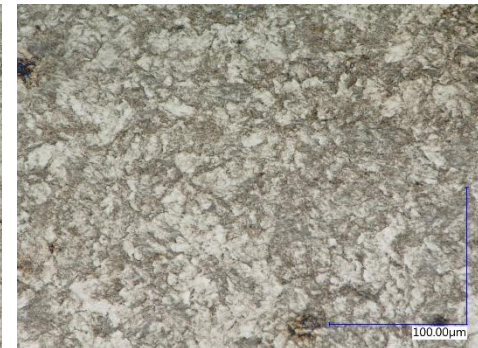
Mikrostruktura w strefie wpływu ciepła w stali R260 w stopce (pow. x1000)
