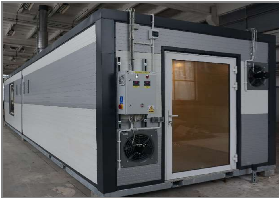
Makieta do testów systemów wykrywania i gaszenia pożarów w Laboratorium Instytutu Kolejnictwa
