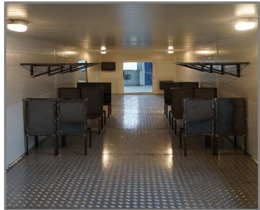
Makieta do testów systemów wykrywania i gaszenia pożarów w Laboratorium Instytutu Kolejnictwa
