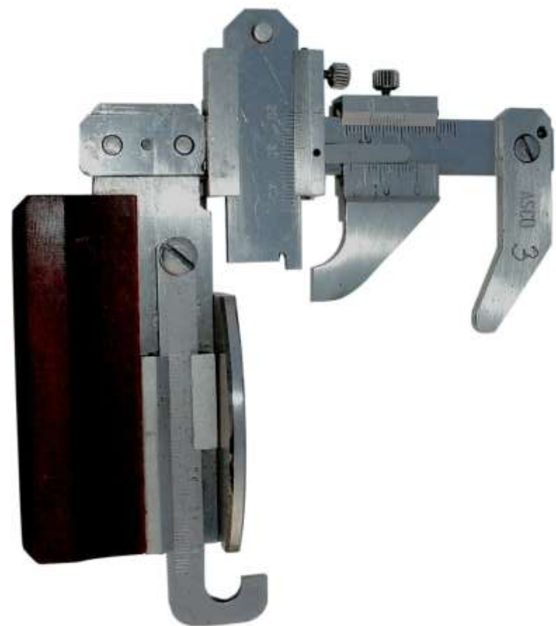
1 - ramię oporowe suwniarki, 2 - prowadnica, 3 - ramię oporowe prowadnicy, 4 - suwak z ruchomą szczęką krawędziową, 5 i 6 - śruby zaciskowe, 7 - suwak krzyżowy, 8 - zacisk, 9 - wysuwka, 10 - listwa, 11 - płytki bazowa, 12 - powierzchnie pomiarowe płaskie, 13 i 14 - krawędzie pomiarowe, 15 - powierzchnia pomiarowa walcowa.
