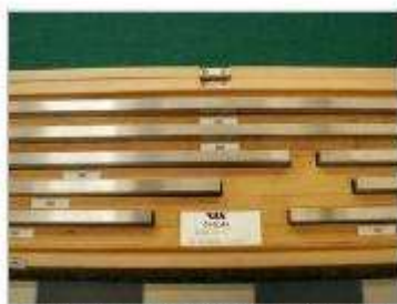
Płytki wzorcowe o d. nominalnej (125 ± 500) mm
