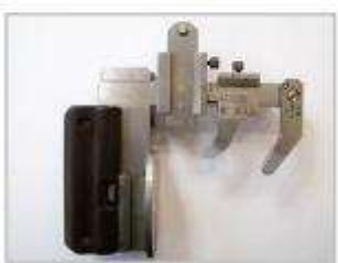
Suwmiarki do pomiaru grubości zarysów
