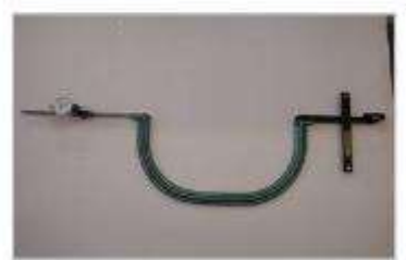
Przyrządy do pomiaru średnicy okręgu tocznego ze stykami dwupunktowymi
