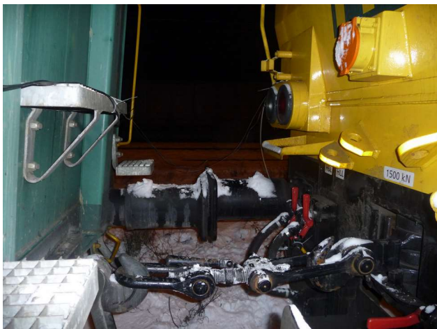
Rys. 1 Sprzęg śrubowy łączący lokomotywę z wagonami
