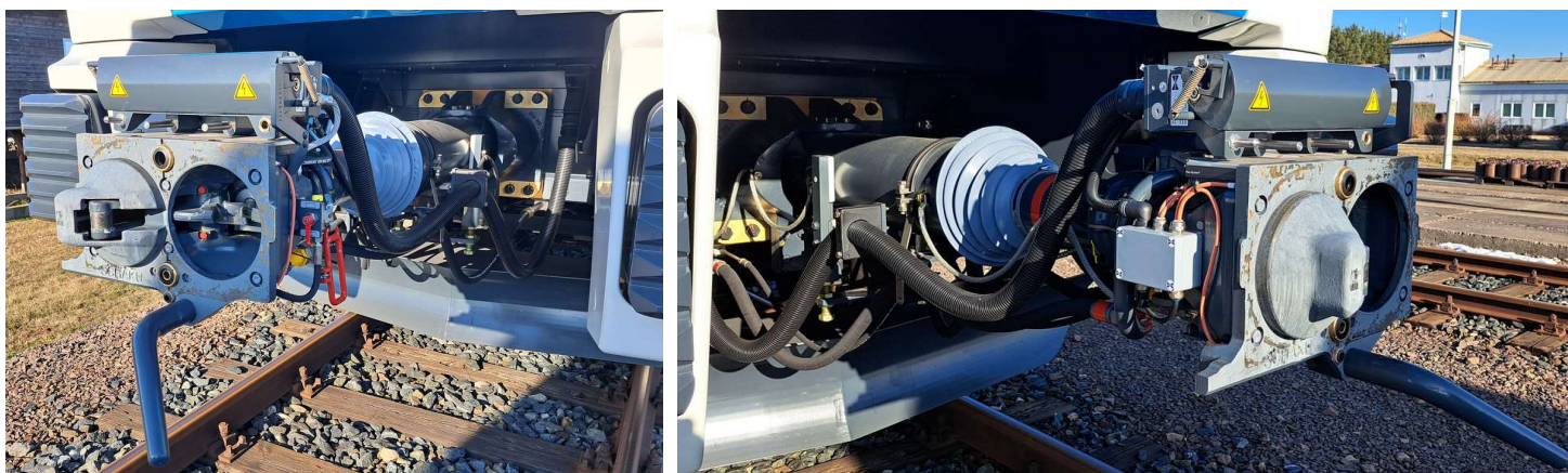
Rys 20. Ogólny widok sprzęgu typu Scharfenberg zamontowanego na SZT
