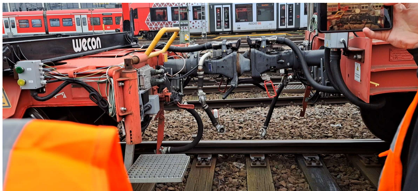
Rys 38. Wagony wyposażone w sprzęgi DAC podczas testów sprzęgania
