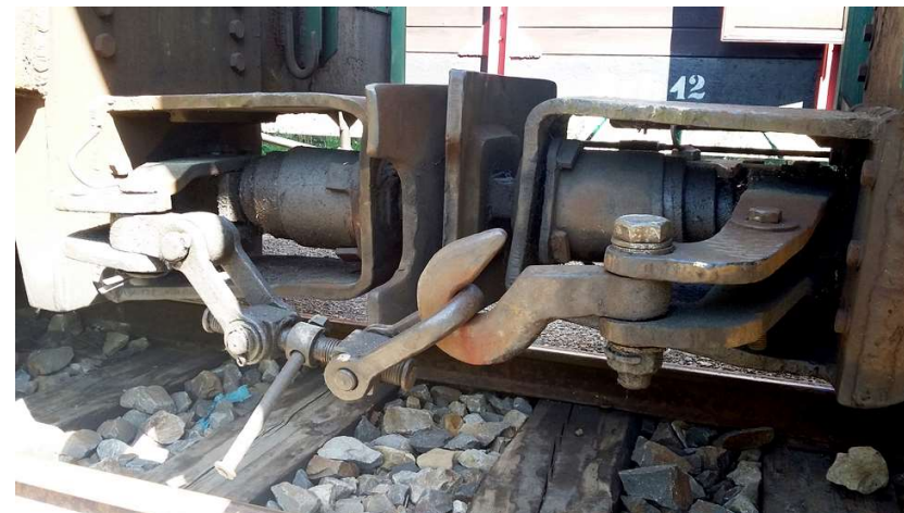
Rys. 3 Sprzęg śrubowy orczykowy stosowany w pojazdach wąskotorowych
