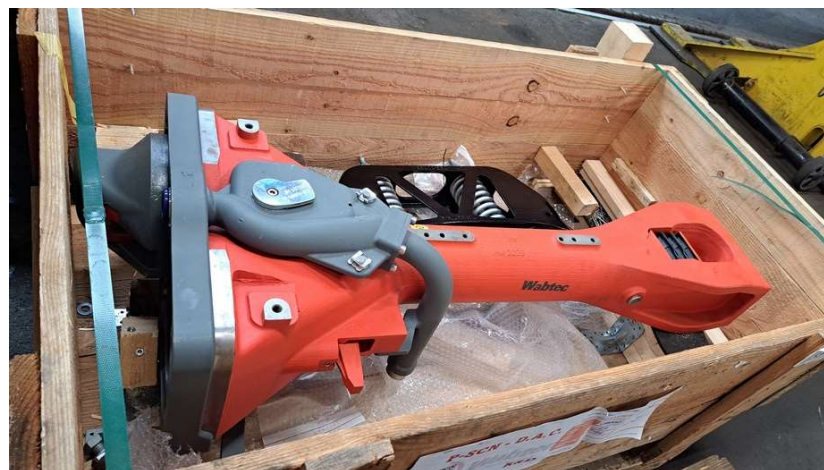
Rys 32. Widok przykładowych sprzęgów DAC przed montażem
