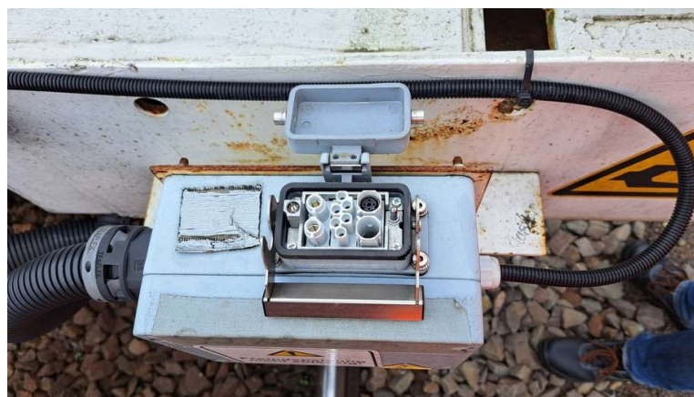
Rys 37. Przyłącza elektryczne wagonów wyposażonych w sprzęgi DAC
