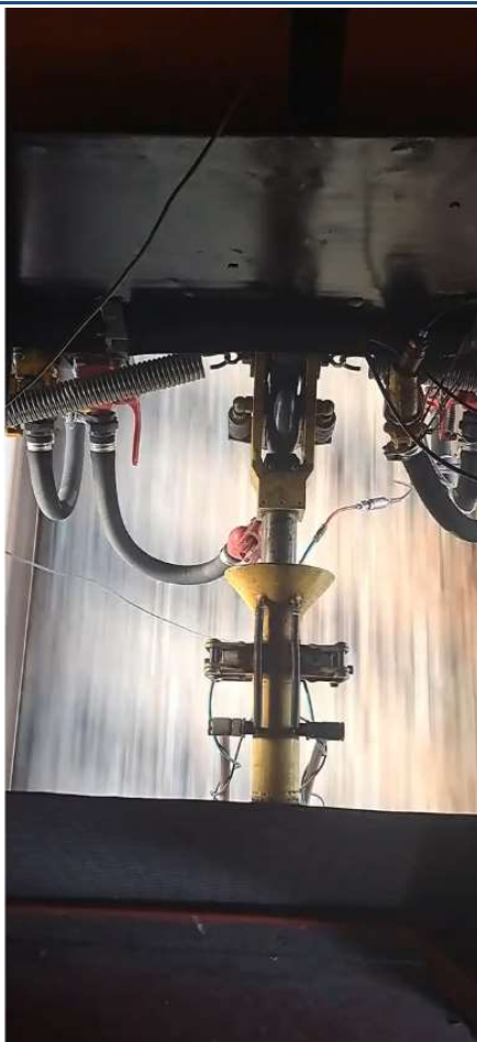
Sprzęg automatyczny Instytutu Kolejnictwa stosowany w badania hamulców wagonów
