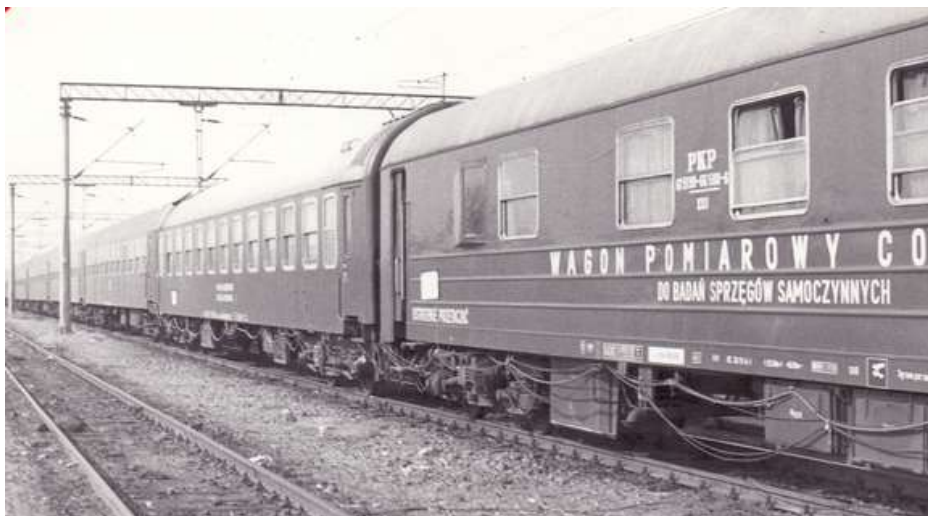
Rys 13. Pociąg pomiarowy COBiRTK do testów sprzęgów samoczynnych UIC/OSŽD
