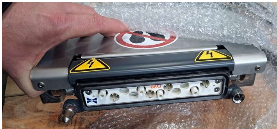
Rys 37. Przyłącza elektryczne wagonów wyposażonych w sprzęgi DAC
